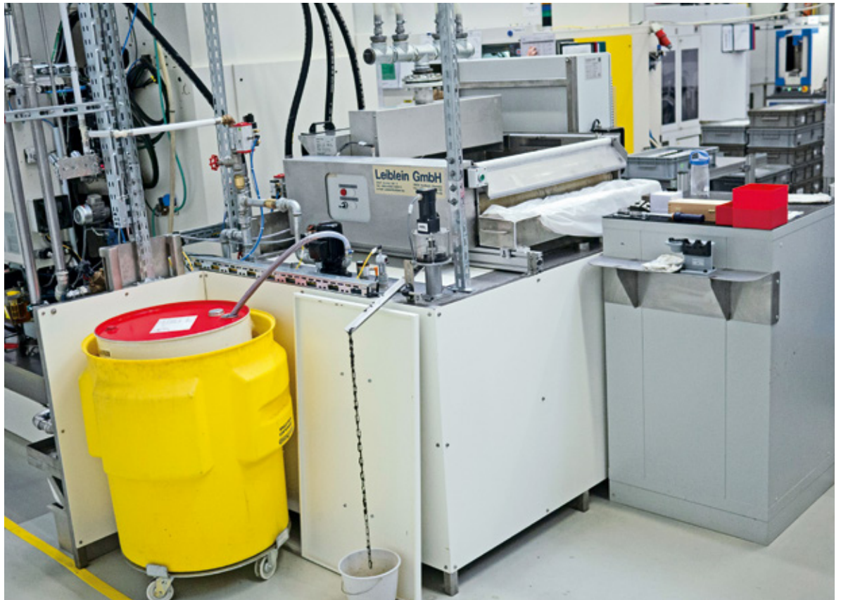
An der Rückseite der Aufbereitungsanlage steht das Fass mit Robsol, RobMations hauseigenem KSS-Konzentrat
